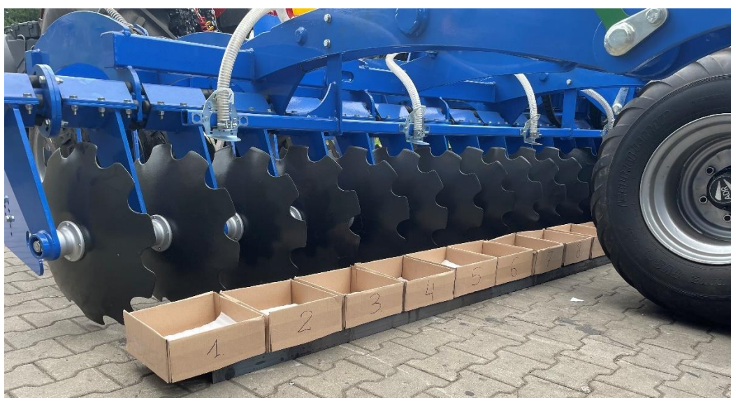
Rys. 12. Widok ustawienia pudełek do oceny równomierności wysiewu nasion
