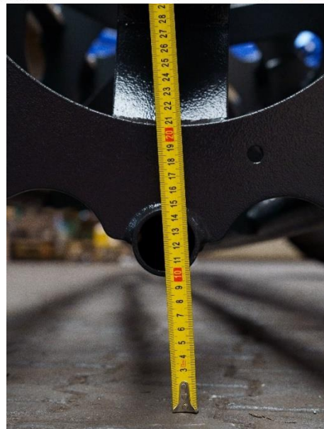
Rys. 5. Pomiar położenia wału rurowego – ustawiona głębokość pracy 10 cm
