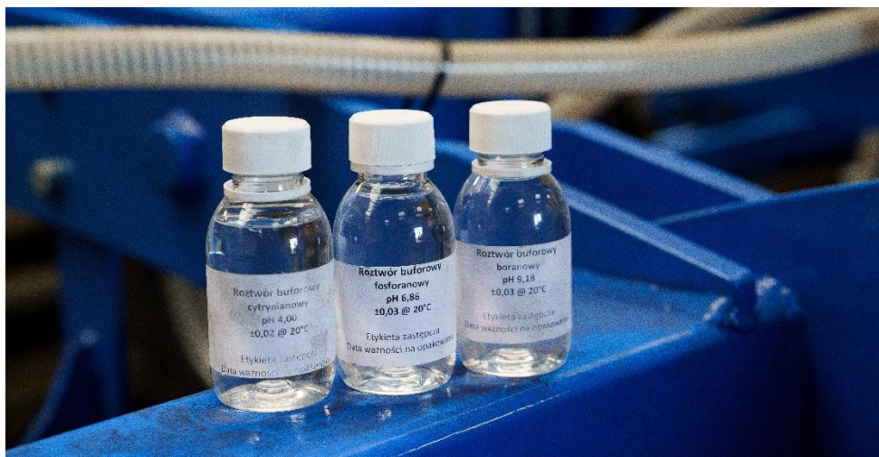
Rys. 6. Widok butelek z trzema wzorcowymi roztworami
