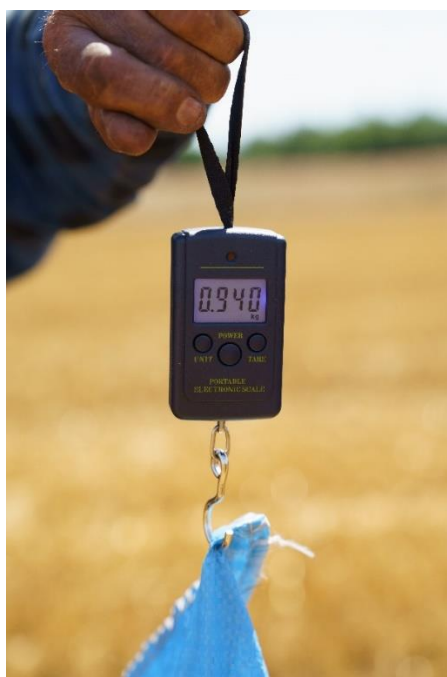
Rys.34. Pomiar plonu (masy) słomy zebranej z powierzchni 1 m 2
