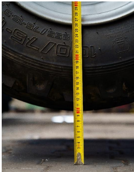
Rys. 4. Pomiar położenia koła – ustawiona głębokość pracy 10 cm
