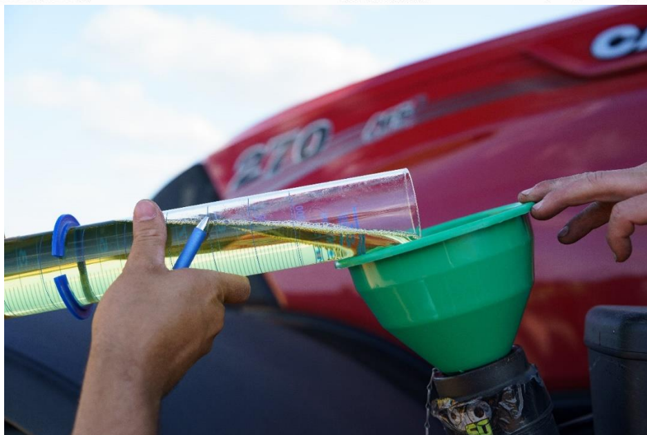
Rys. 44. Uzupełnianie ilości paliwa w zbiorniku po wykonanym zabiegu uprawowym
