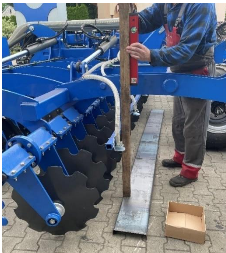
Rys. 14. Ustawianie podestu względem sekcji wysiewających (wysokość 5 cm)
