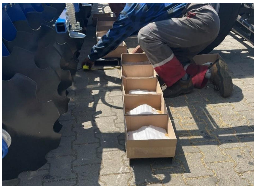
Rys. 16. Badania laboratoryjne równomierności wysiewu nasion gorczycy: podest o wysokości 5 cm, pojemniki ustawione w drugim rzędzie
