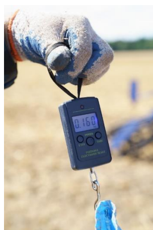
Rys. 52. Pomiar masy odsianych resztek roślinnych z powierzchni 1 m 2
