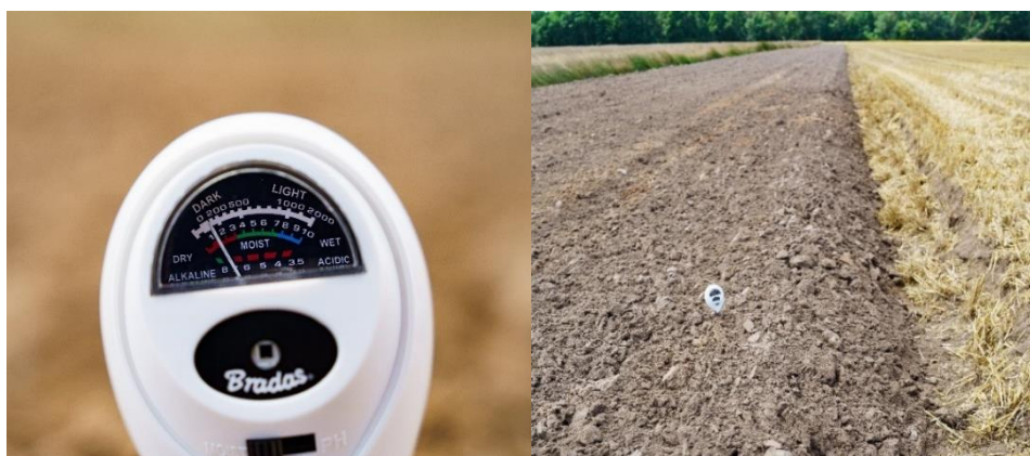
Rys.29. Pomiar wilgotności gleby w uprawie klasycznej (orkowej)
