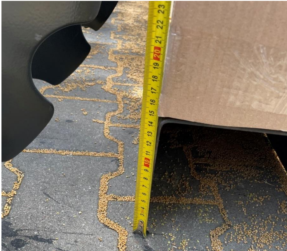
Rys. 21. Ustawianie podestu względem sekcji wysiewających (wysokość 15 cm)
