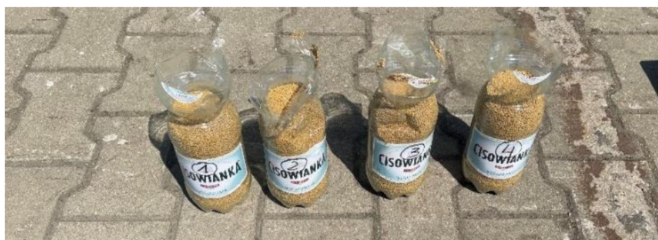
Rys. 23. Widok pojemników z wysianymi nasionami – badanie równomierności rozdziału strugi nasiennej
