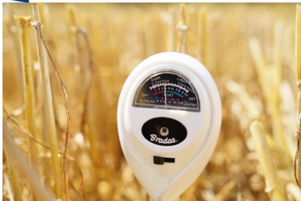
Rys. 31. Pomiar wilgotności gleby w uprawie uproszczonej
