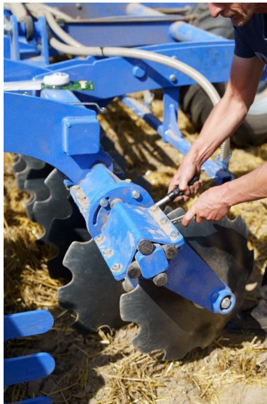
Rys. 36. Regulacja głębokości pracy skrajnego talerza
