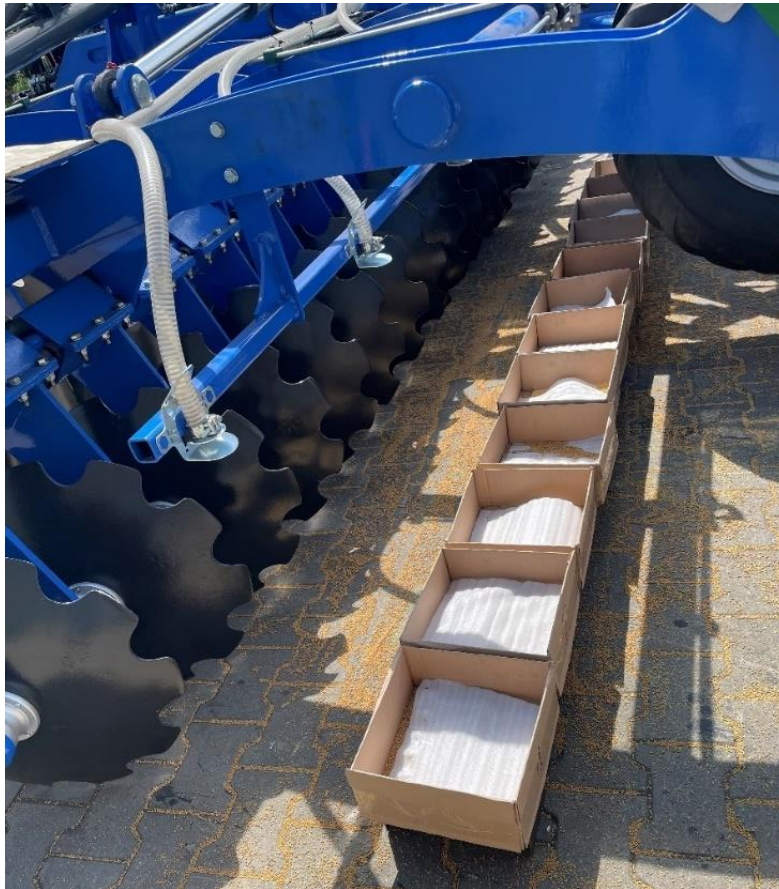
Rys. 20 Badania laboratoryjne równomierności wysiewu nasion gorczycy: podeśt o wysokości 10 cm, pojemniki ustawione w drugim rzędzie
