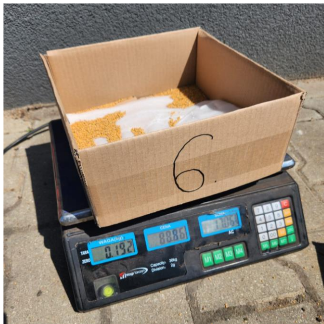
Rys. 18. Pomiar masy nasion w pudełkach – badania równomierności wysiewu nasion
