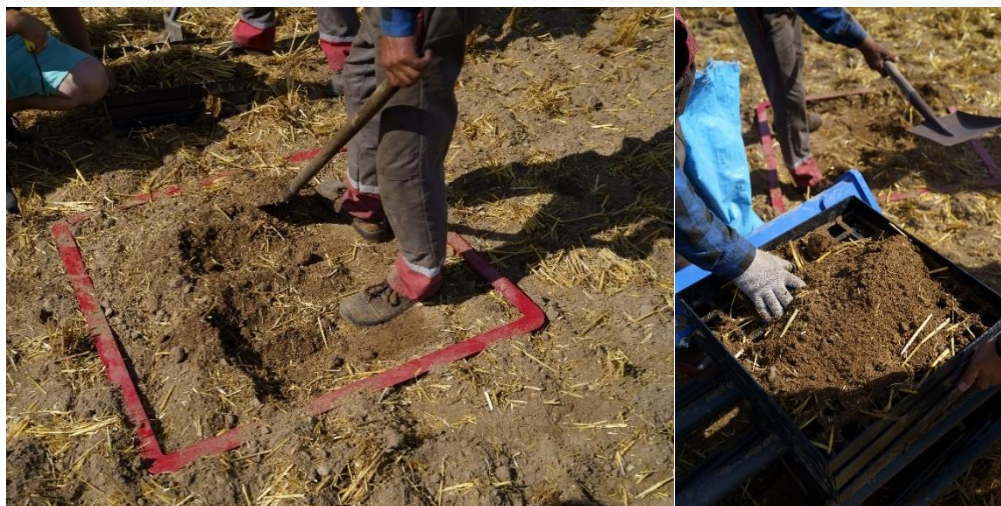
Rys. 54. Widok zbierania wierzchniej warstwy gleby wraz z wymieszanymi resztkami roślinnymi – zakres pomiarowy 0,0÷0,1 m (uprawa uproszczona)
