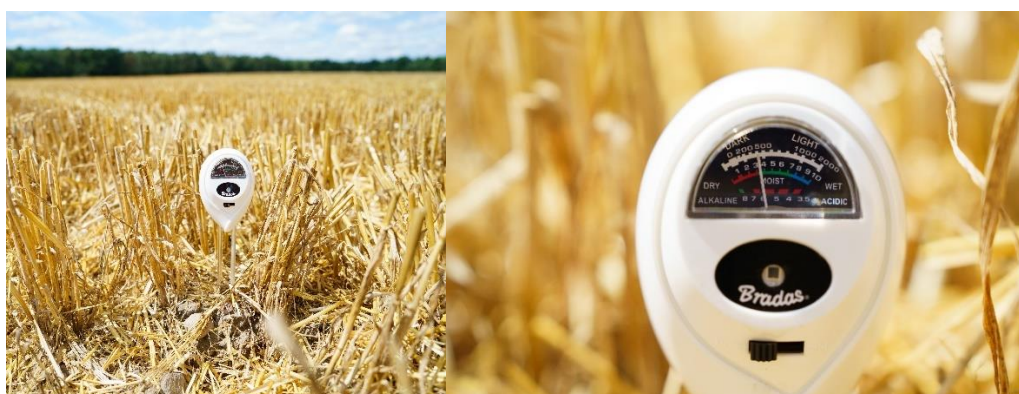
Rys.30. Pomiar wilgotności gleby w uprawie uproszczonej
