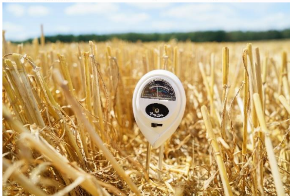
Rys. 31. Pomiar wilgotności gleby w uprawie uproszczonej
