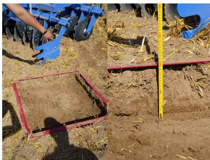
Rys. 56. Widok zbierania warstwy gleby wraz z wymieszanymi resztkami roślinnymi – zakres pomiarowy 0,1÷0,2 m (uprawa uproszczona)
