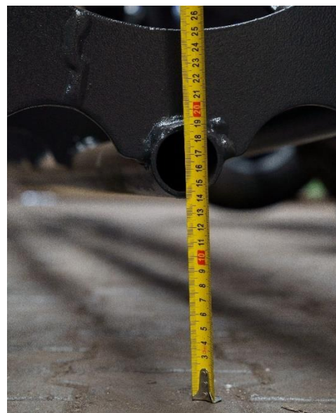
Rys. 3. Pomiar położenia wału rurowego – ustawiona głębokość pracy 14 cm
