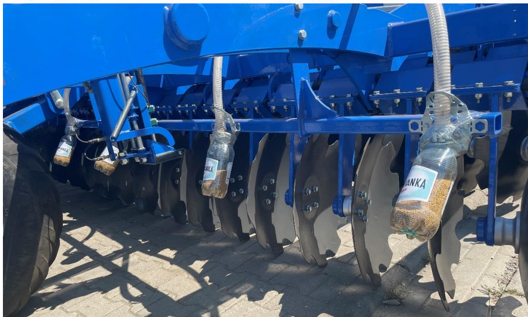
Rys. 13. Widok pojemników do zbierania nasion rozpraszanych 4 sekcjami rozpraszającymi
