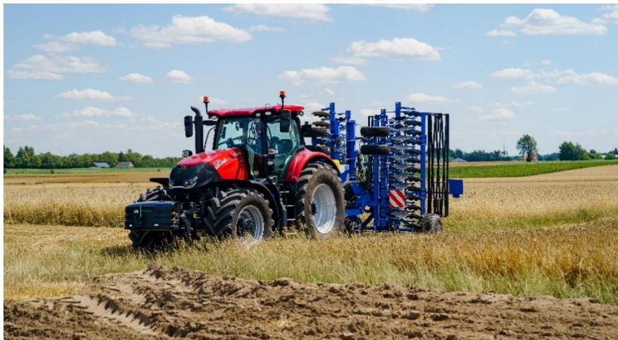
Rys. 25. Widok agregatu w położeniu transportowym
