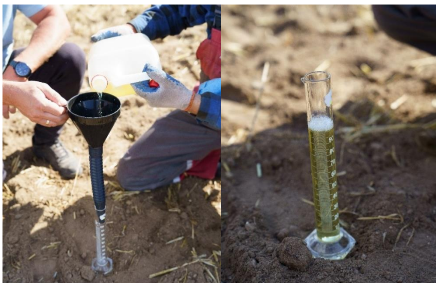
Rys. 45. Napełnianie menzurki pomiarowej ilości paliwa
