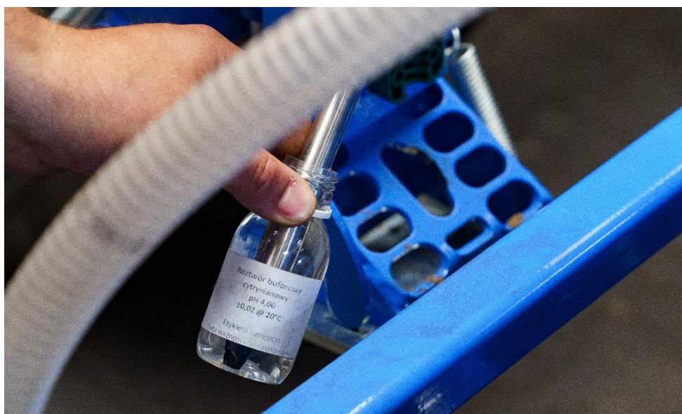
Rys. 7. Pomiar odczynu roztworu – bufor cytrynianowy
