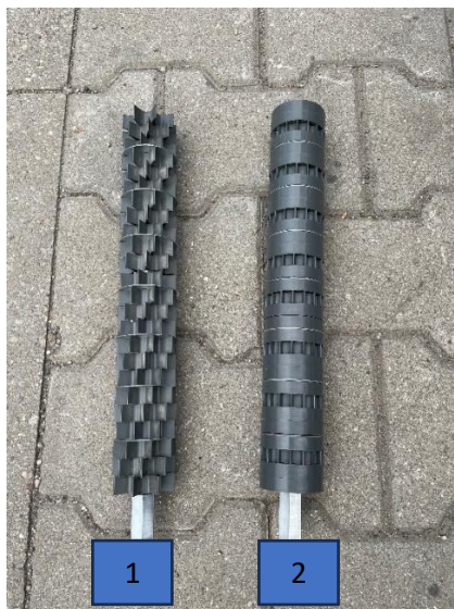
Rys. 5. Widok wałków wysiewających: 1 – wałek do wysiewu nasion średnich, 2 – wałek do wysiewu nasion drobnych
