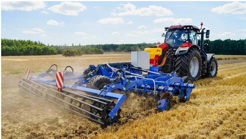
Rys.35. Widok agregatu uprawowo-siewnego podczas wstępnego przejazdu roboczego
