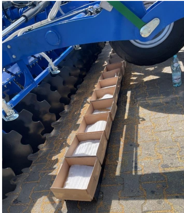
Rys. 22. Badania laboratoryjne równomierności wysiewu nasion gorczycy: podeście o wysokości 15 cm, pojemniki ustawione w drugim rzędzie
