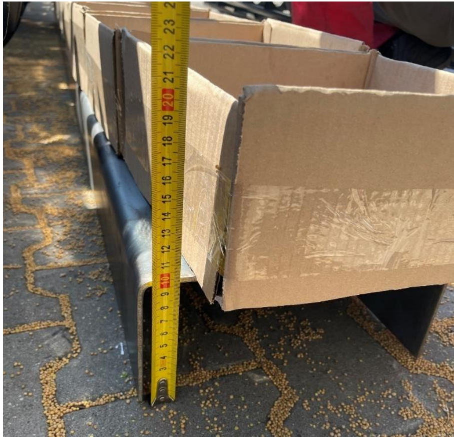
Rys. 19. Ustawianie podestu względem sekcji wysiewających (wysokość 10 cm)
