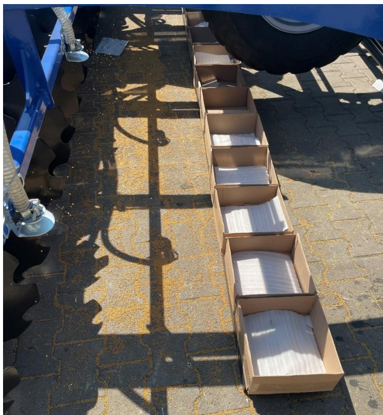
Rys. 17. Badania laboratoryjne równomierności wysiewu nasion gorczycy: podeście o wysokości 5 cm, pojemniki ustawione w trzecim rzędzie
