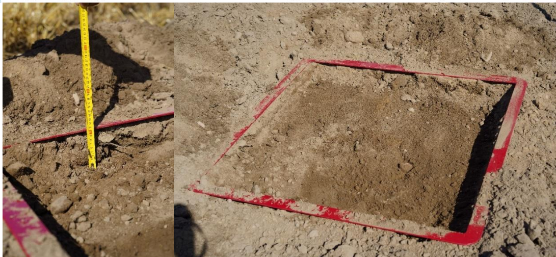
Rys. 57. Pomiar głębokości wybierania warstwy gleby wraz z resztkami roślinnymi – zakres pomiarowy 0,0÷0,1 m (uprawa klasyczna)
