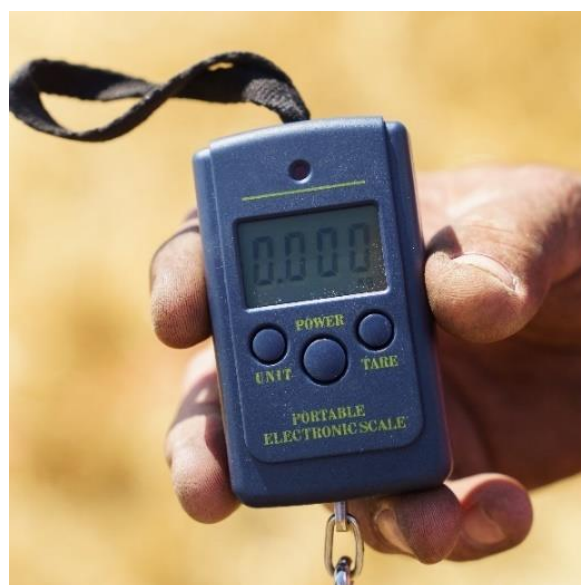
Rys. 9. Widok wagi do pomiaru masy nasion gorczycy
