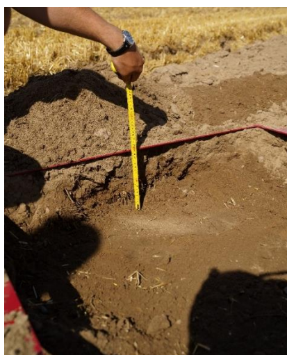
Rys. 58. Pomiar głębokości wybierania warstwy gleby wraz z resztkami roślinnymi – zakres pomiarowy 0,1÷0,2 m (uprawa klasyczna)
