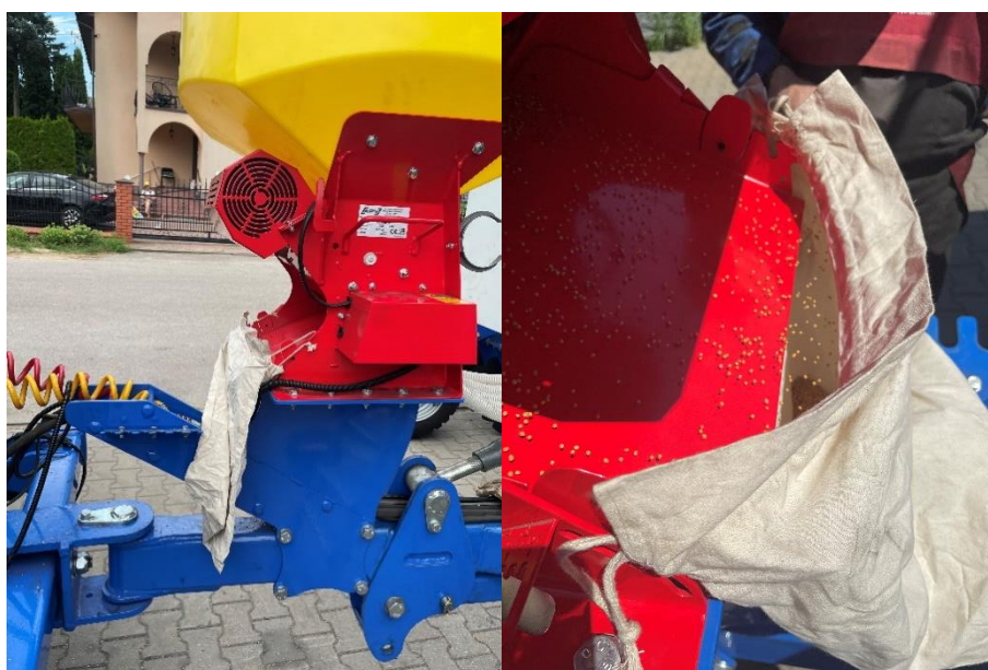
Rys. 8. Próba kręcona siewnika do poplonów
