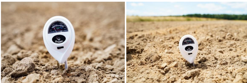
Rys. 28. Pomiar wilgotności gleby w uprawie klasycznej (orkowej)
