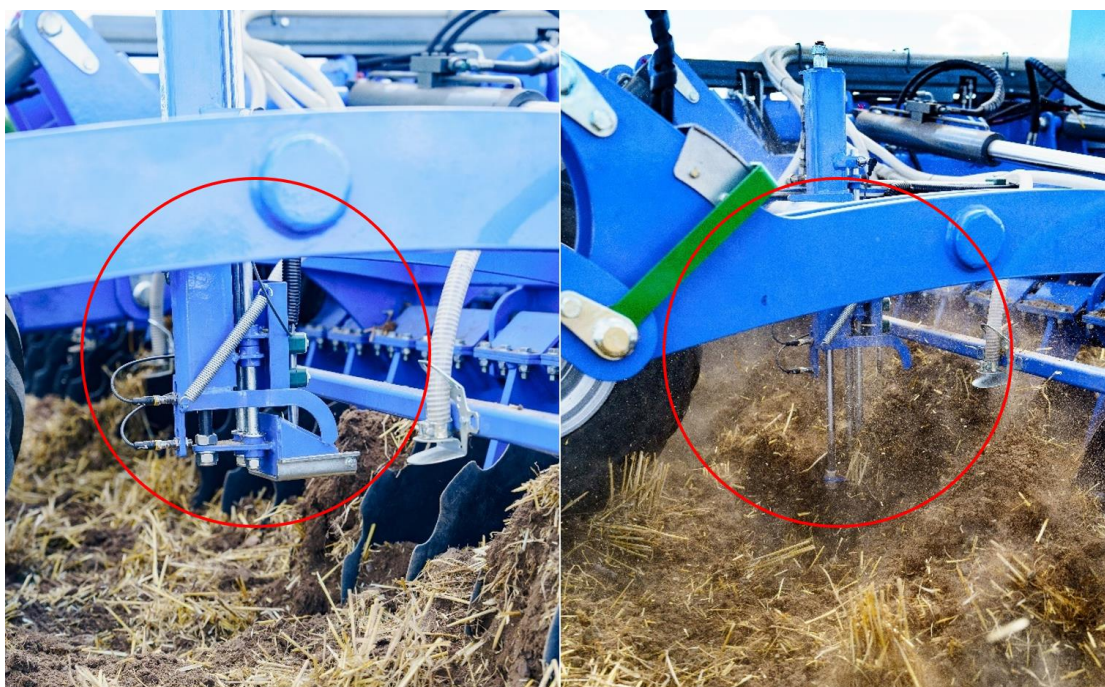
Rys.40. Widok układu do pobierania prób glebowych
