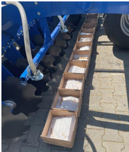
Rys. 15. Badania laboratoryjne równomierności wysiewu nasion gorczycy: podest o wysokości 5 cm, pojemniki ustawione w pierwszym rzędzie
