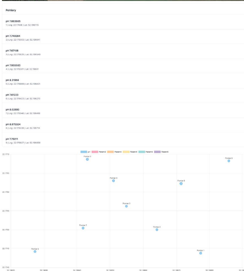
Rys.42. Widok interfejsu programu z zaznaczonymi przejazdami oraz punktami poboru prób glebowych wraz z wartościami odczynu gleby (pH)
