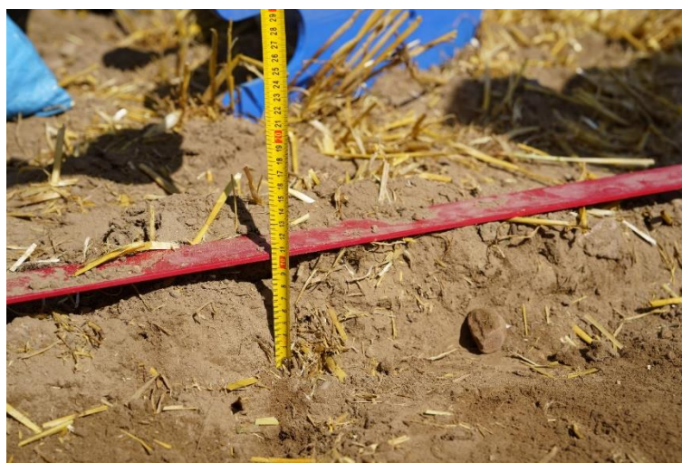
Rys. 55. Pomiar głębokości wybierania warstwy gleby wraz z resztkami roślinnymi – uprawa uproszczona
